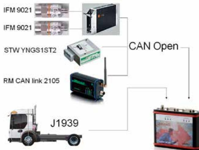
Figura 3.10. Sistema de adquisición de datos para un vehículo de recolección de basura. Fuente: [149].
