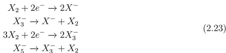
Por otra parte, en el proceso de descarga (Figura 2.21) se produce un suministro de electrones, como consecuencia de la contribución energética provocada por la reacción electroquímica del electrodo pseudocapacitivo (2.24). Asimismo, existe un incremento en la tasa suministro de energía, debido a la interacción de electrones proveniente del electrodo de doble capa eléctrica.
