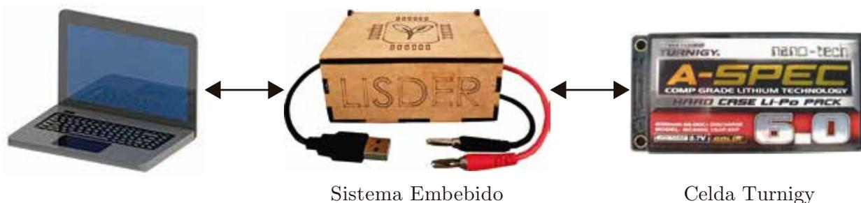
Figura 3.16. Caracterización experimental de una celda de LiPo marca *Turnigy*.
