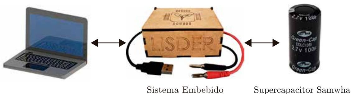
Figura 3.23. Caracterización experimental de un supercapacitor EDLC marca *Samwha*.
