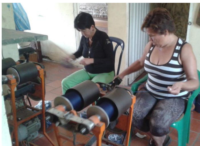
Figura 129. Hilado de fique en torno eléctrico
