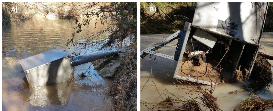
Figura 53. El 2 d'octubre de 2015 es va registrar la crescuda més gran de les últimes dècades a la Ribera Salada, deixant la meitat de les estacions hidromètriques fora de servei. (A) L'estació d'Inglabaga va quedar tombada, va perdre els sensors i el data-logger es va fer malbé, perdent així les dades. Aigües amunt, a l'estació de (B) Canalda, els sensors van quedar soterrats sota una capa de graves i sorres, mentre que la caixa va caure a la llera i es va omplir de sediments fi.
