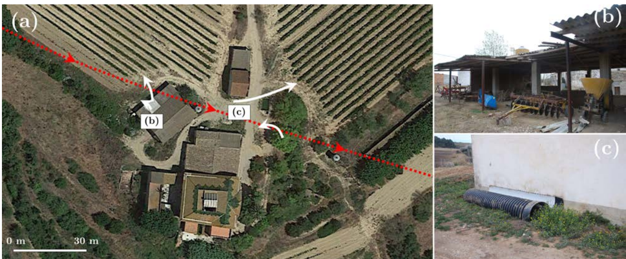
Figura D.3: (a) Mapa amb la trajectòria de les restes localitzades a la finca afectada pel tornado, on s'indiquen els elements malmesos presentats a les fotografies (b) cobert d'uralita afectat i (c) tubs desplaçats per la força del vent. La línia vermella puntejada mostra la trajectòria del tornado.
