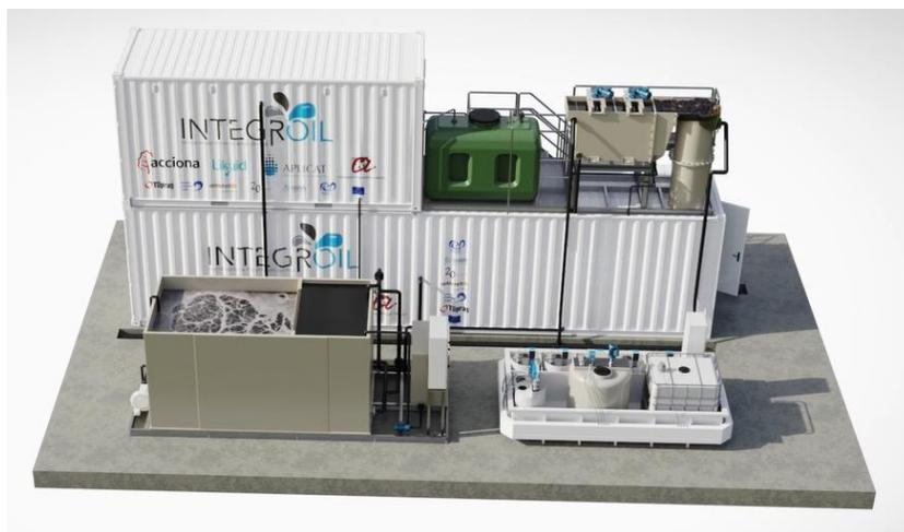
*Figura 3. 2 Conjunto modular de los diferentes tratamientos del proyecto Integroil.*
