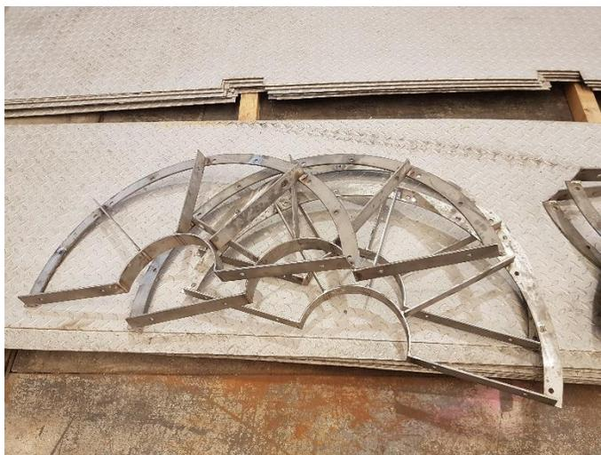
*Figura 4. 6 Soportes de malla interna de los reactores*
