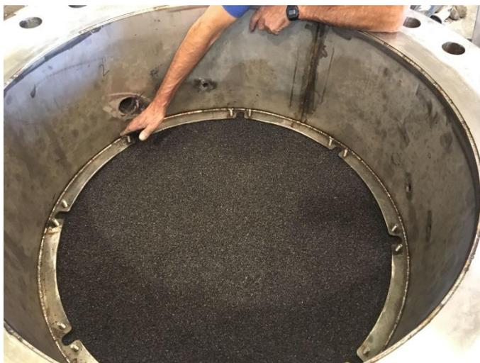
*Figura 4. 7 Reactor relleno de catalizador, sin malla superior.*
