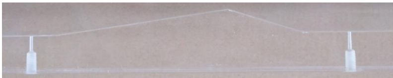
Figura 49: Detalle de la ubicación de los sensores de presión en el Venturi real.
