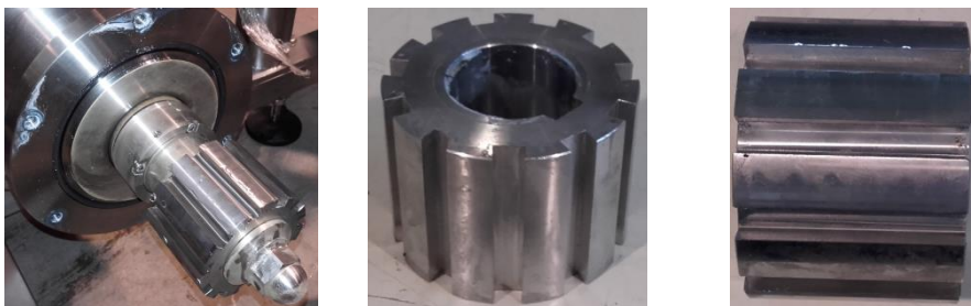
Figura 34: Detalle del rotor real en el dispositivo de cavitación.
