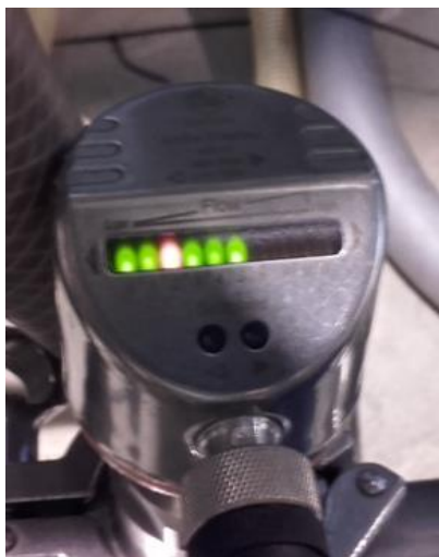
Figura 115: Caudalímetro de leds indicando un caudal de 100 l/min.
