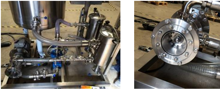
Figura 128: Sistema de cavitación utilizado en la planta piloto (el mismo que en la experimentación de laboratorio).
