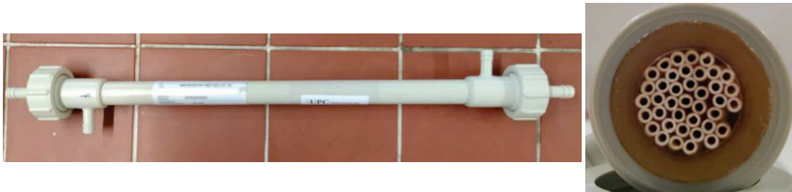
Figura 8-1: Mòdul de MBR (esquerra) i detall d'interior del mòdul (dreta)
