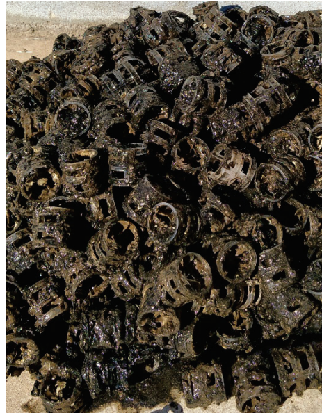
Figura 6-4: Material desordenat net (esquerra) i cobert de llots (dreta) després de 40 dies
