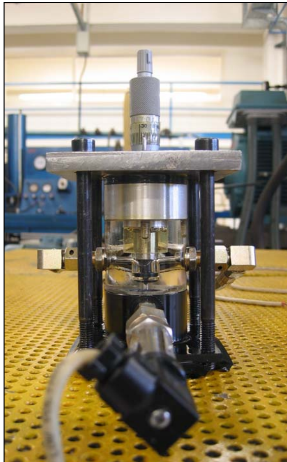
Fig 6. 1 Muntatge proves experimental de obturador fix
