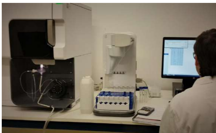
Figure 3.7. ICP-AES instrument (Agilent 4200 MP-AES).
