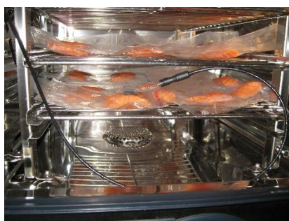
Figura 7 | Cámara del horno y sonda para el registro de temperatura interna.
