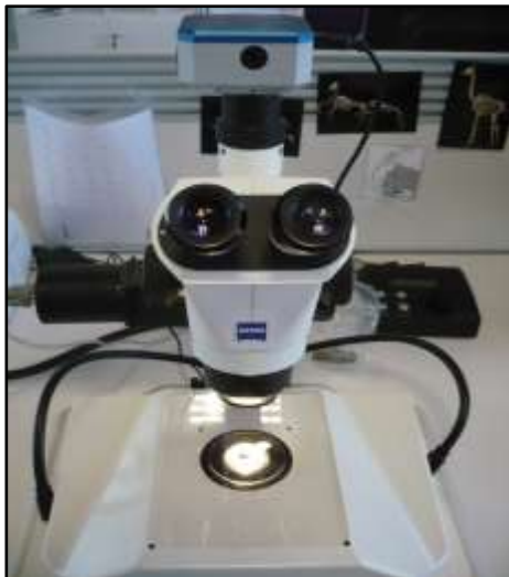
Figura 22. Estereomicroscopi òptic Zeiss Stemi 2000C i la font d'alimentació associada CL1500 ECO. A la part superior del estereomicroscopi s'observa la càmera DeltaPix Invenio 5SII.
