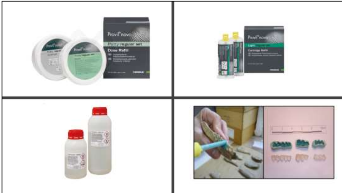
Figura 20. A la part superior, i d'esquerra a dreta, silicones d'alta i baixa resolució; a la cantonada inferior esquerra, base i catalitzador de la resina epoxídica utilitzada; a la cantonada dreta inferior, obtenció dels motlles negatius amb la pistola per a la silicona d'alta resolució i resultats dels motlles en positiu de resina transparent.
