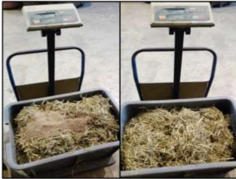
Figura 30. Procés de pesada i barreja de l'alfals fresc picat amb el sediment.
