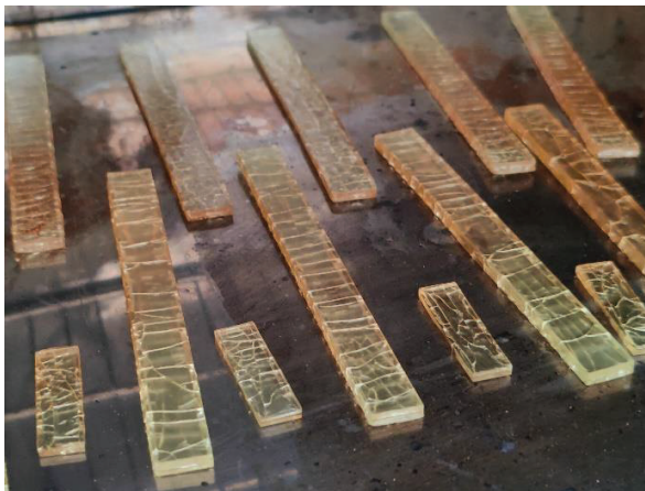
Figura 7-5 Imatge de l'aspecte de les provetes de resina HT60 un cop fet el tractament tèrmic.
