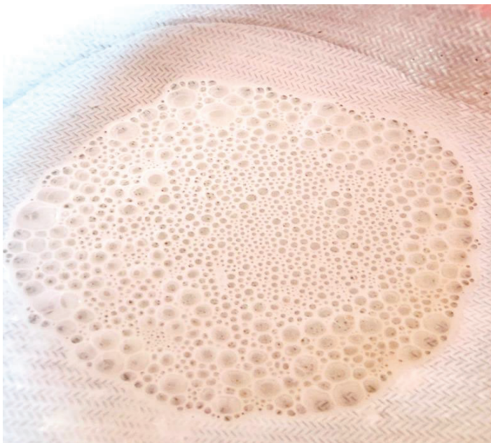
Figura 4-16 Imatge de les bombolles formades durant el procés de mescla d'una formulació amb contingut en alumina i dispersant però sense antiespumant.
