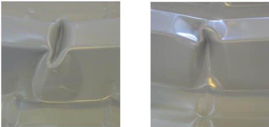
Fig.6.Modos de fallo: tipo A y B (Casariego, 2014)
