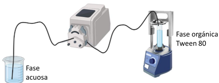
Figura 44. Sistema de formación de nano-emulsión semi-automatizado. Consta de una bomba dosificadora que mueve la fase acuosa a un flujo fijo hacia el tubo en agitación en un vórtex, donde cae gota a gota, manteniendo una alta reproducibilidad.
