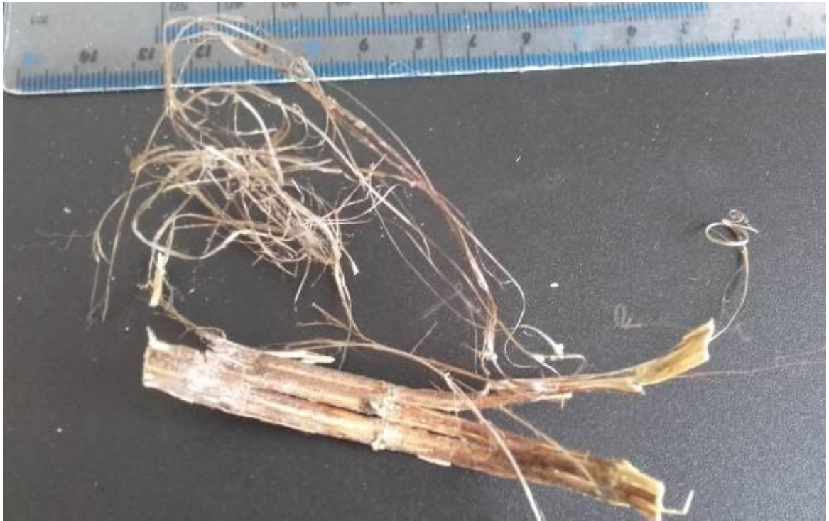
Figura 21: Extracción de la fibra del tallo de la ortiga. Experimentación para la obtención de fibra de ortiga.
