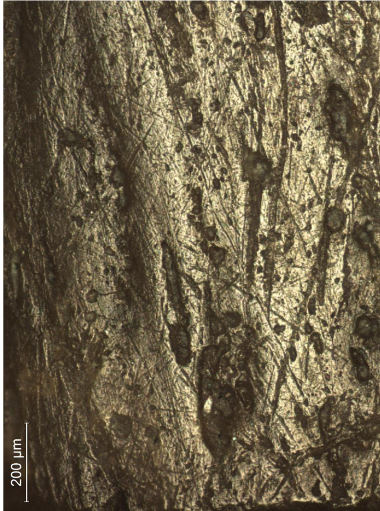
Figura 37: Microtopografía ondulada observada a 100 aumentos, que además presenta zonas elevadas y otras más profundas donde no ha llegado el pulido, por lo que se observan más oscuras. Punzón arqueológico de La Draga 1501.
