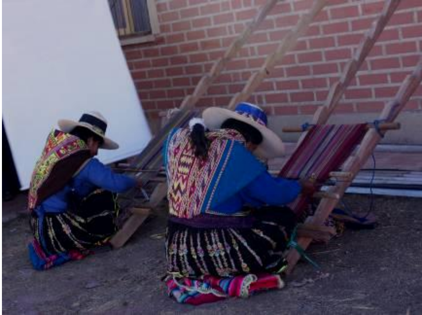
Figura 82: Tejedoras andinas actuales tejiendo siguiendo los métodos de tejido prehispánico en telar horizontal recostado sobre un muro. Se observa en la imagen la estructura de madera atada con cordeles, y los palos travesaños y lizos que lo componen. Fuente: Elvira Espejo, archivo MUSEF, Museo Nacional de Etnografía y Folklore de Bolivia.
