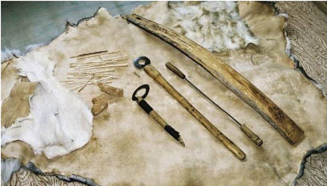
Figura 31: Instrumentos típicos empleados en el trabajo de la piel y raspadores: a la izquierda de la imagen se observa un raspador con el área distal puntiaguda (tipo punzón), a continuación un raspador de borde dentado, también un raspador de hoja lisa sin afilar. Fuente: Klokkernes 2007: 73 fig. 3.38, presentado por Tomskaya Rosalia Ivanovna, EgerovaMaria Ivanovna y StepanovaValentinaVasilievna, en Kharyyalach, Sakha República, Rusia, 2004.
