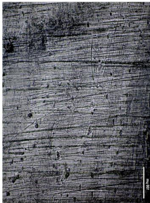
Figura 94: Detalle de las huellas de uso de punzón experimental que trabajó con piel. Fuente: Equipo IMF-CSIC.
