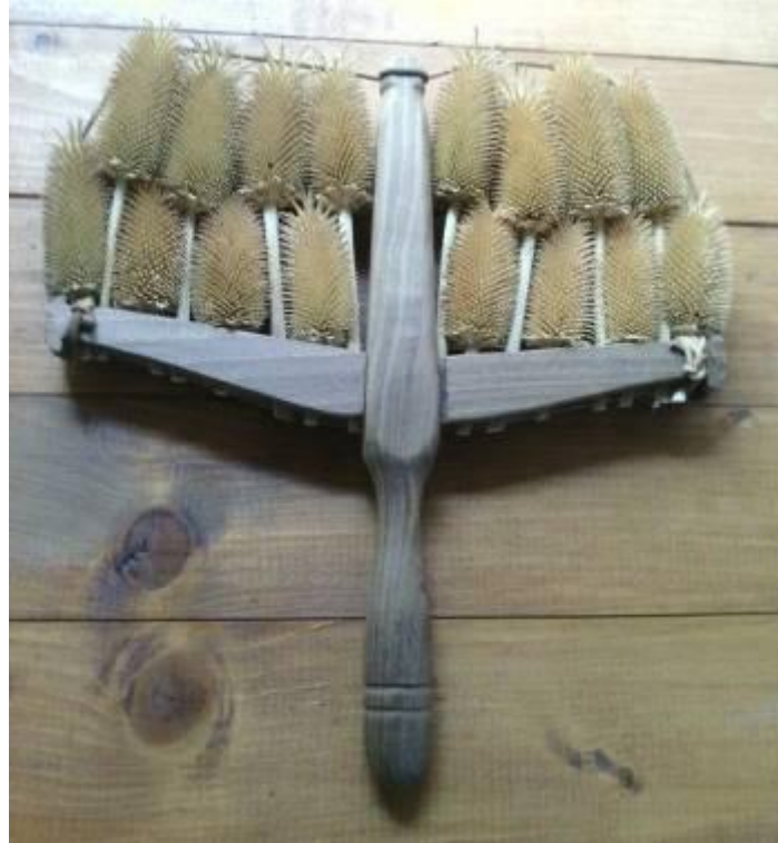
Figura 146: Carda de cardos para cardar lana elaborada por un artesano gallego, según un ejemplar del Museo Textil de Val de San Lorenzo. Fuente: Pinterest 26
