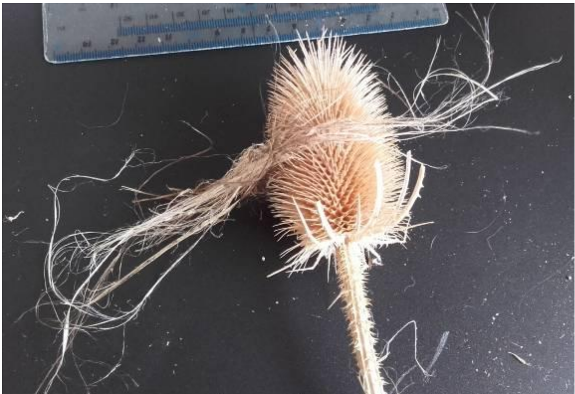
Figura 22: Cardado de la fibra de ortiga para preparar la fibra para el siguiente proceso: el hilado. Experimentación para la obtención de fibra de ortiga.
