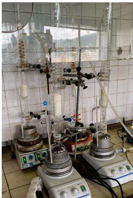
Figura 5.11: Montajes de extracción Soxhlet refrigerados en serie
