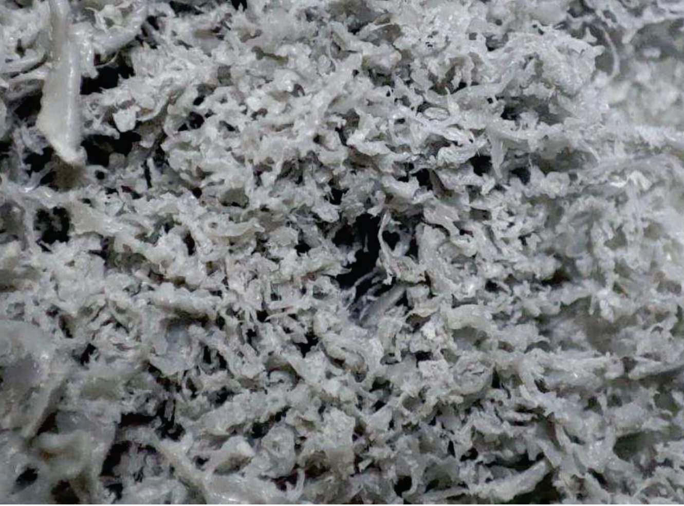
Muestras de PP-R extraídas de cartuchos con tamaño homogeneizado para TGA o HPLC
