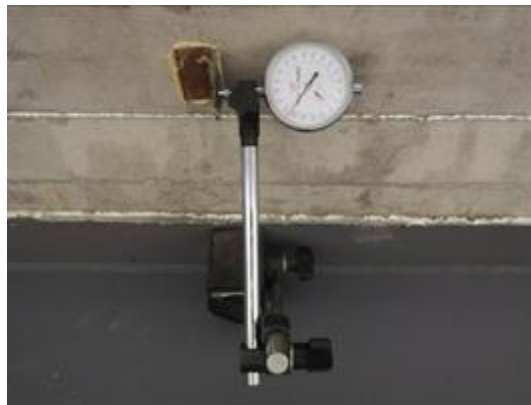
(d) Installation of dial indicators
