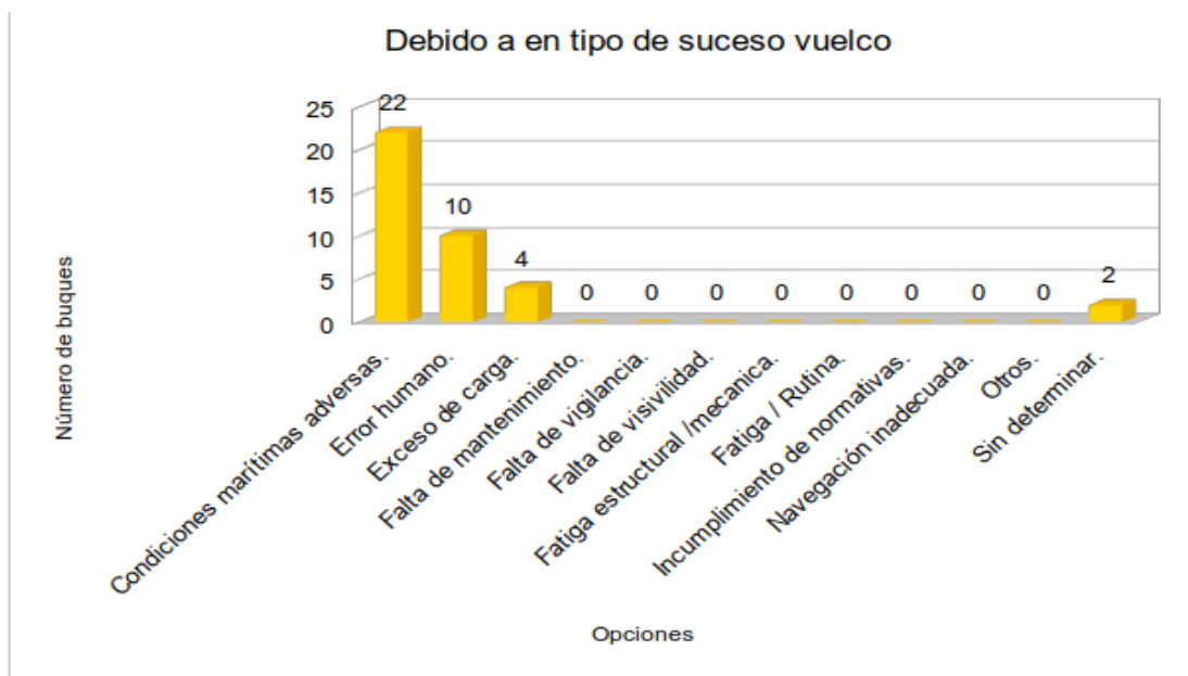
Figura 124. Causa debido a qué tipo de suceso vuelco. Fuente: autor.
