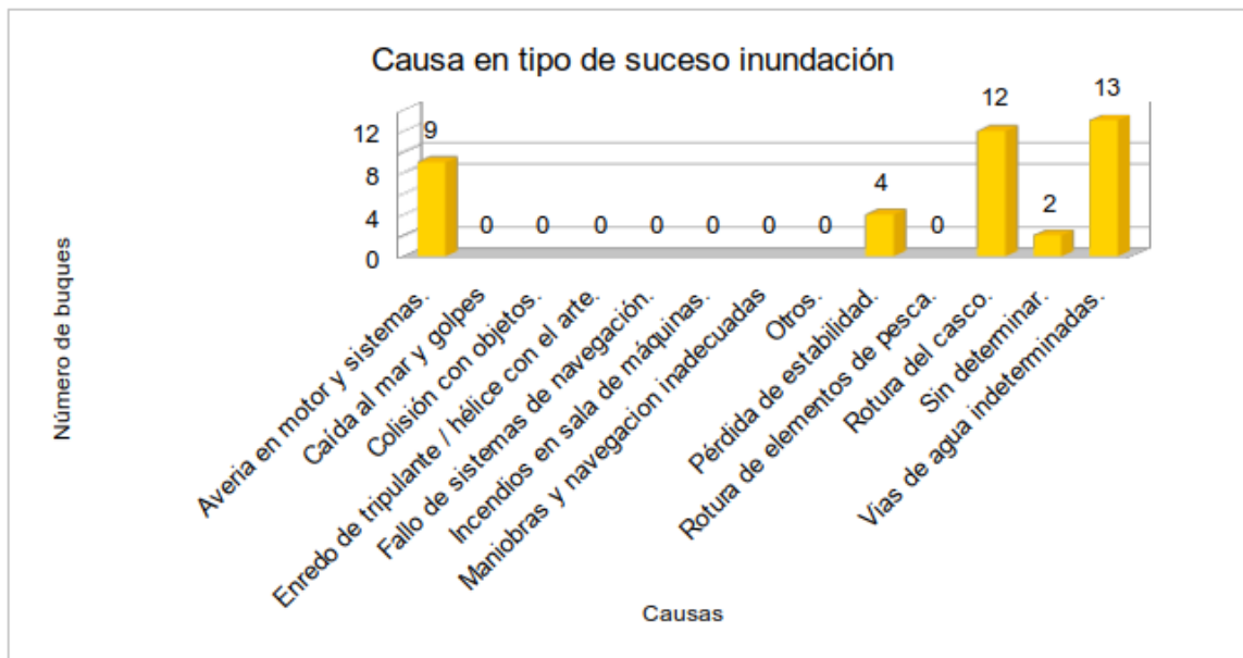
Figura 116. Causa del accidente en tipo de suceso de inundación. Fuente: autor.
