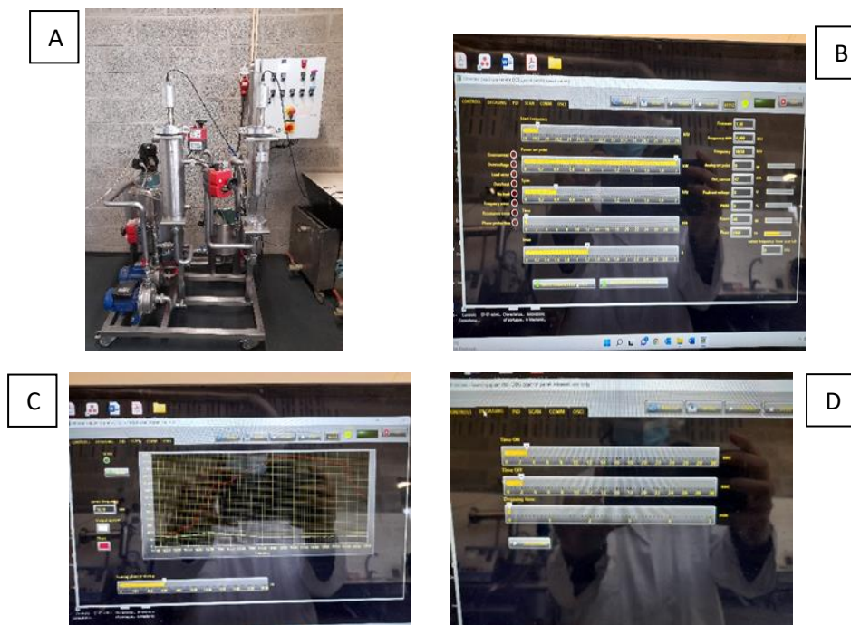
FIGURA 10. Equipo de tratamiento por ultrasonidos. A) Prototipo ultrasonidos, B) Pantalla de calibración del equipo, C) Curva de calibración y D) Pantalla de ajuste de los parámetros del proceso.
