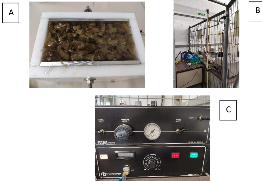
FIGURA 9. Equipo para tratamiento con pulsos eléctricos de la Universidad de Lleida. A) cámara de tratamiento, B) lanza aislante y C) panel de control.
