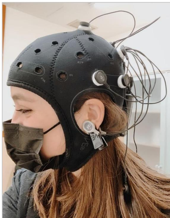
**Figura 38.** Disposición del aparato de estimulación y los electrodos en uno de los participantes. Con permiso expreso. Fuente: Elaboración propia.
