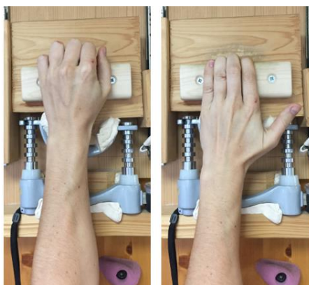
Figura 27. Dinamometria Jamar adaptada al gest esportiu de la mà escaladora, simulant preses en arqueoig i en extensió. Fotografies de N. Carnicero, Hand Therapy BCN.
