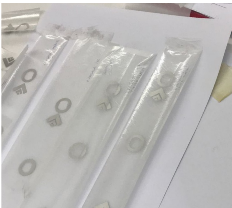
Figura 4.25. Ensayos que, al pasar por el horno, se arrugaron o quedaron inutilizables. Imágenes propias.
