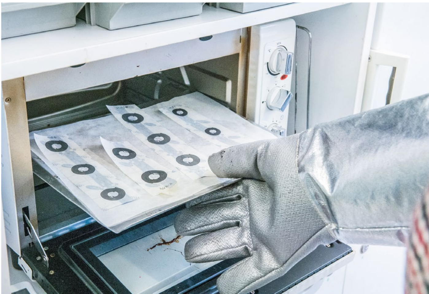
Figura 4.31. Curado de las muestras. Imágenes propias.
