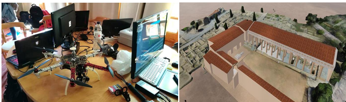
Figura 5.2. izquierda: el dron utilizado y el ordenador procesando las fotografías, derecha: montaje del modelo fotogramétrico y el modelo 3D de la edificación (ágora y estoa), fuente: elaboración propia.
