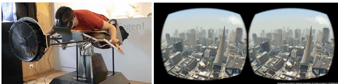
Figura 2.16. En la experiencia Birdly de la Universidad de las Artes de Zurich, el usuario, que lleva unas gafas de RV, agita sus “alas” mientras vuela de forma virtual sobre San Francisco. Una plataforma de movimiento y un ventilador proporcionan una estimulación sensorial adicional. La figura de la derecha muestra el estímulo presentado a cada ojo, fuente: LaValle.
