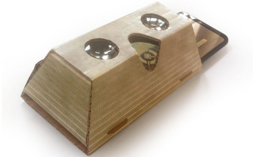
Figura 6.17. Gafas diseñadas de RV, fuente: elaboración propia
