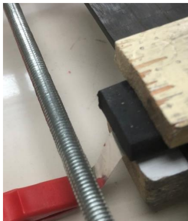
Figura 4-38.- Detalle del montaje del electrodo completo de aluminio para una coordenada de la probeta.
