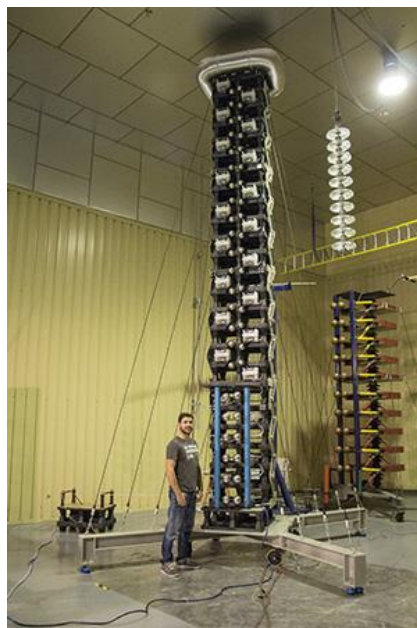
Figura 6-18.- Resultado final del generador de Marx modular fabricado.
