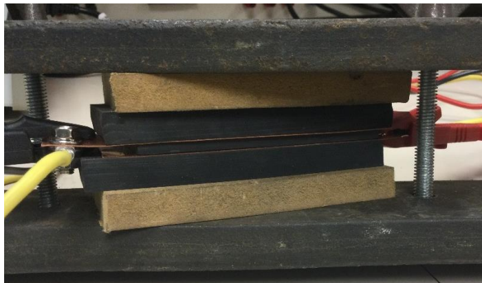
Figura 4-15.- Montaje para determinar, por el método de los 2 puntos, la dependencia de la resistencia de la probeta con respecto a la corriente, en la dirección Z (perpendicular a las fibras).
