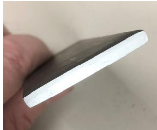
Figura 4-27.- Detalle de la superficie de contacto de la probeta donde se ha aplicado la pintura de plata para la medida de la resistividad en la dirección X.
