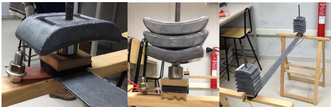
Figura 4-1.- Detalle de cómo se variaba la presión sobre los contactos superficiales añadiendo peso sobre ellos.
