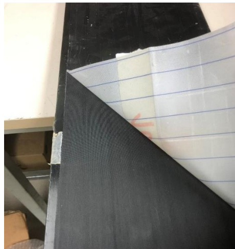
Figura 2-8.- Probeta de carbono donde se está eliminando la peel ply para su posterior fase de pulido.
