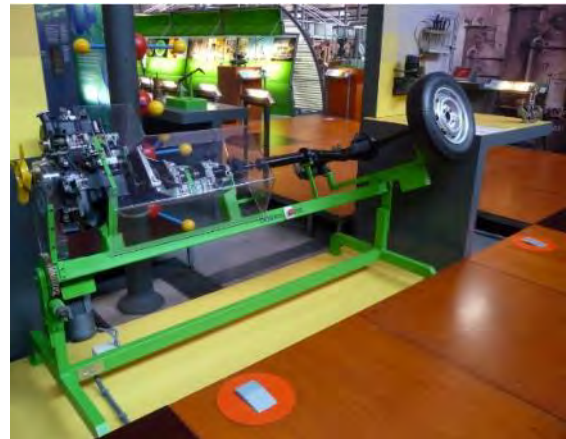
Figura 36: interactivo mecánico que explica el funcionamiento de la dirección, accionable por el visitante. Museu Nacional de la Tècnica de Catalunya (Terrassa, España). Fuente: autoría propia.
