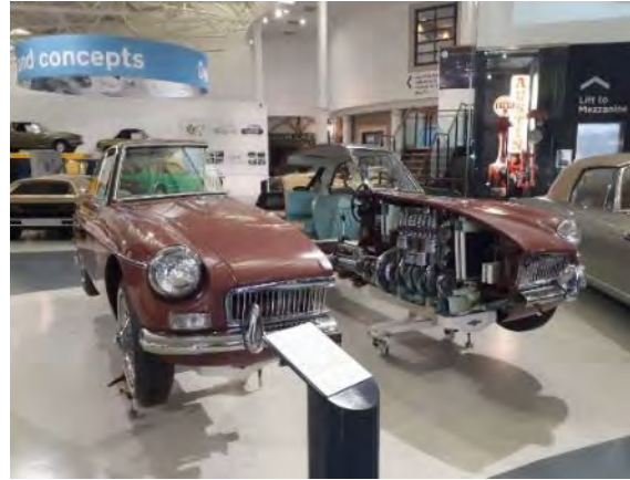
Figura 32: ejemplo de automóvil seccionado. British Motor Museum (Gaydon, Reino Unido). Fuente: autoría propia, 2018.
