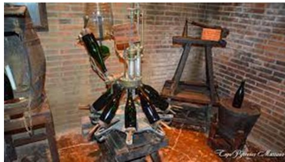
Figura 69: Mecanismo que se utilizaba para dosificar el licor de expedición en las botellas. Fuente: Archivo Codorníu
