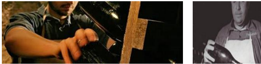
Figura 44: Otro detalle del removido manual de las botellas. Fuente: Archivo Codorníu
