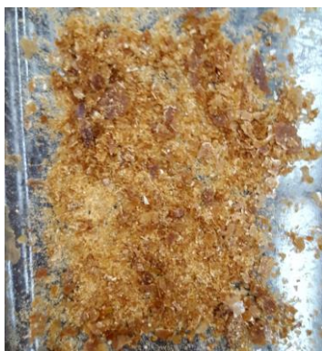
Figura 8. Pectina extraída de cáscara de maracuyá, después de los procesos de extracción, filtrado, precipitación y secado.
