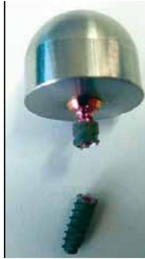
Figura 17. Implante fracturado durante un ensayo de fatiga in vitro 1 .
