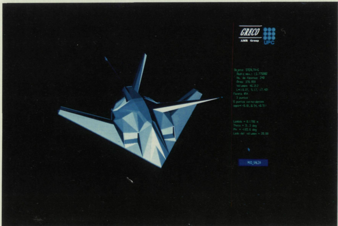
Figura 7-5: Modificación manual de la posición de un vértice de las facetas.
