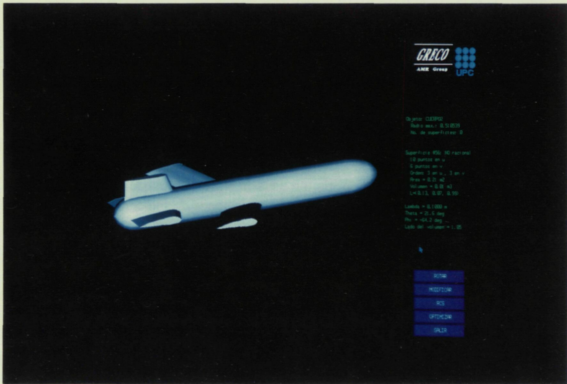
Figura 7-2: Avión modelado con superficies paramétricas.
