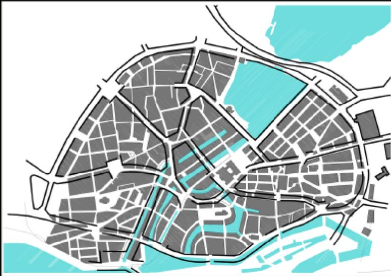
Representación esquemática de la reorganización vial del centro de la ciudad, según un plano de Karl Schneider de 1949. (El plano resume sus propuestas en ese sentido elaboradas entre 1945 y 1947). El autor sugiere el trazado de la avenida Este-Oeste sobre parte del canal *Zollkanal*, que es el que separa a la ciudad de los almacenes de *Hafenstadt*. Esta propuesta se nutre en lo que se refiere a la nueva avenida de las de Ollo Christophersen y de las Hubert Hoffman. Dibujo del autor.
