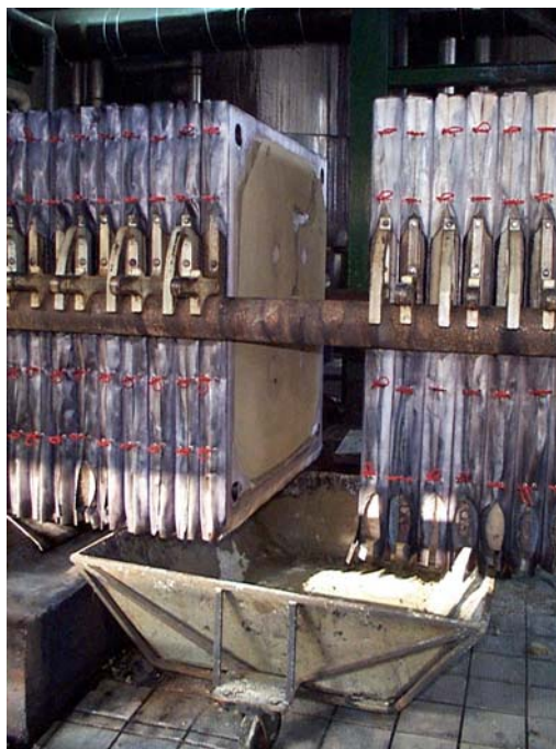
Figura 4.33. Filtro prensa F-406 de polipropileno utilizados en el experimento a escala piloto.
