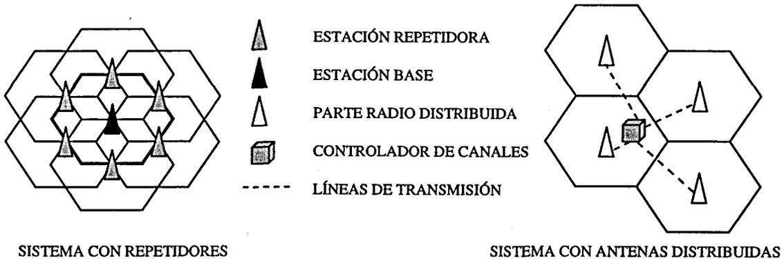
Figura 6.9.10 Áreas de cobertura de un sistema con 6 estaciones repetidoras y otro con antenas distribuidas omnidireccionales con un controlador de canales para 4 partes radio.
