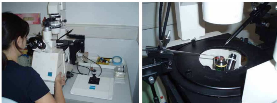
Fig.10. Izquierda: Microdisector manual, se observa en primer plano el mando (joystick) que permite desplazar el microposicionador que maneja la aguja. Derecha: Imagen previa a la transferencia de material desde la aguja (en la imagen en la parte superior) a la pipeta (en la zona izquierda).
