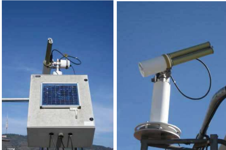
Figura 3.2: (esquerra) Cimel CE318 i la caixa amb la placa fotovoltaica on es guarda l'electrònica de l'instrument. (dreta) Detall del capçal òptic durant una mesura
