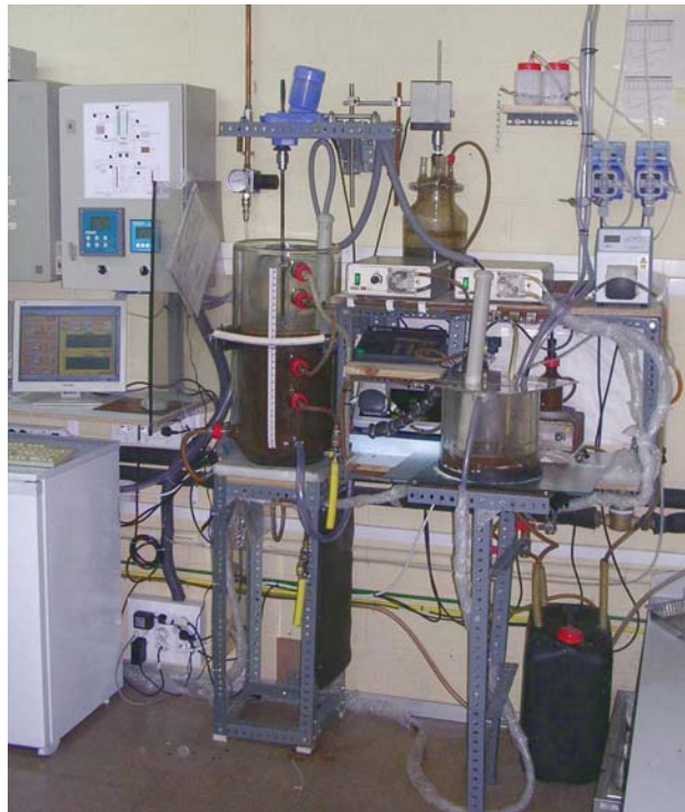
Figura 3.1. Vista de la unitat de tractament SBR i el respiròmetre al LEA (UdL).
