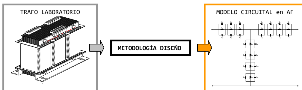
Figura CIV.1. Objetivo capítulo IV: método para hallar el modelo circuital en AF de un transformador.
