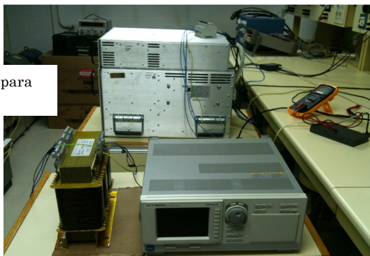
Figura K.2.- Utilización de un solo devanado secundario.
