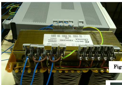
Figura K.3.- Disposición de elementos para los ensayos de vacío y cortocircuito.
