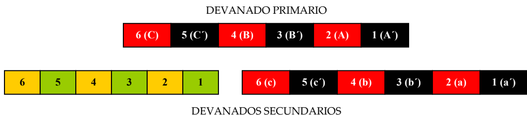
Figura CII.44.- Bornes de los devanados del transformador de laboratorio.
