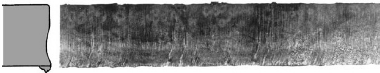
Figura 2.18: Boquilla de oxicorte sucia.
