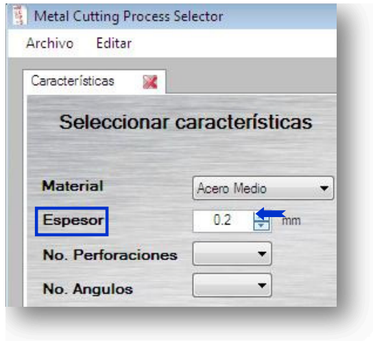
Figura A.9: Procedimiento para seleccionar el espesor.
