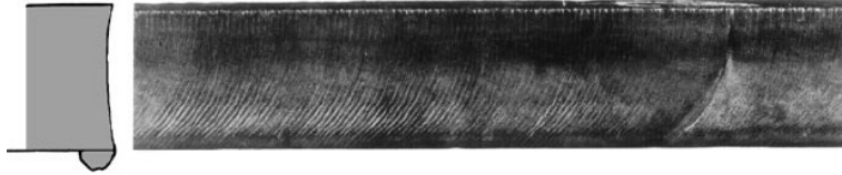
Figura 2.13: Velocidad de oxicorte muy elevada.
