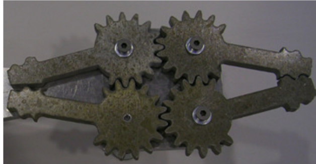
Figura 7.1: Mecanismo Fabricado para tren de Lavado. Cortesía de Girbau.
