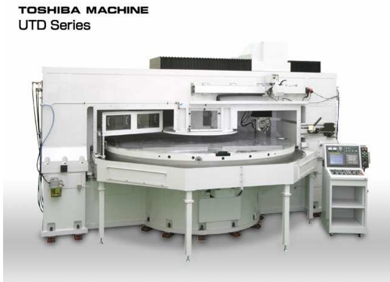
Figura 3.1. Máquina de fabricación de lentes de Fresnel de gran tamaño. Fuente: TOSHIBA.
