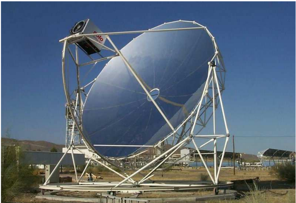
Figura 1.7. Concentrador disco parabólico con un motor Stirling en la Plataforma Solar de Almería (PSA).
