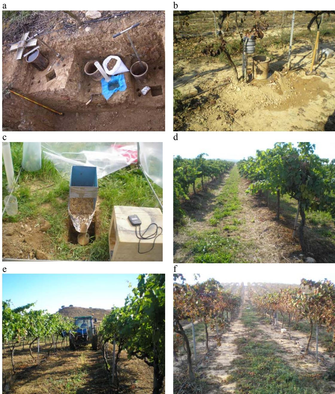
**Fig. 8.** (a) Conductividad hidráulica del suelo medida en los peldaños de la calicatas de los sitios estudiados, visualizándose las muestras sacadas de densidad aparente, saturación, capacidad de campo extraídas con barrena y resistencia a la penetración realizadas simultáneamente; (b) Calibración de los FDR; (c) Simulación de lluvia; (d) Plano con Chardonnay (e) Loma con Tempranillo; (f) Bajo con Tempranillo.
