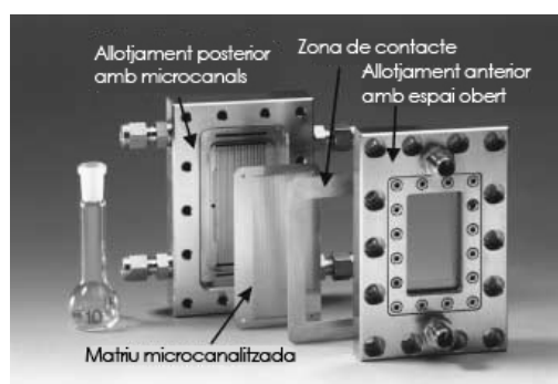
Figura 21: Microreactor amb matriu microcanalitzada amb finestra 166
