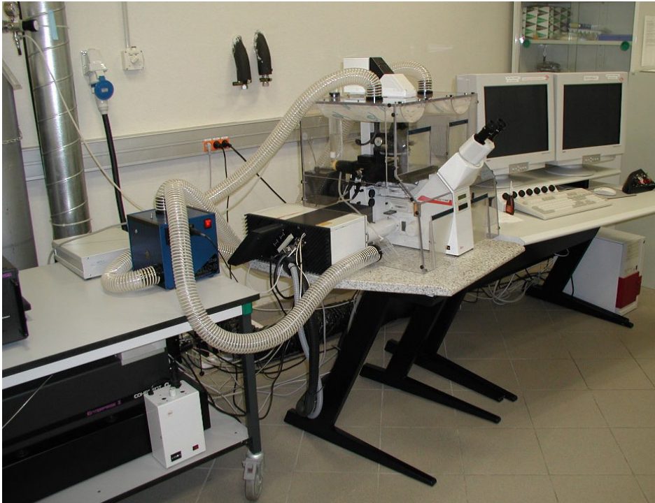
Figura 3.5. Microscopio confocal Leica TCS SP2 adaptado al microscopio invertido Leitz DMIRBE con control de temperatura y CO 2 utilizado en los experimentos de time-lapse o tiempo retardado.
