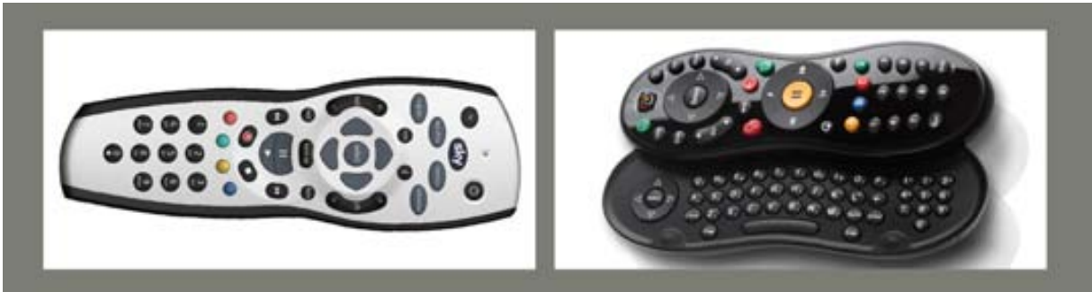
Ilustración 7 – Ejemplos de mandos con botones de interactividad (SKY UK) y con teclado integrado (TiVoSlide).
