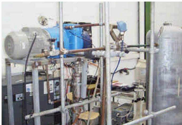
Fig.3. 21. Vista lateral del dispositivo experimental construido para la caracterización experimental del compresor de aire.
