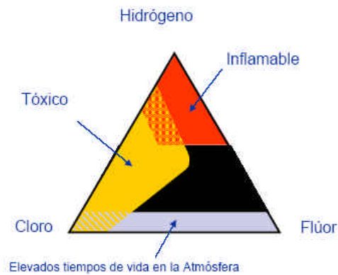
Fig.1. 14. Influencia de la composición en Cloro, Hidrógeno y Flúor en la inflamabilidad, toxicidad y tiempo de vida de los refrigerantes.
