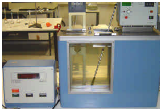
Fig. A.9. Vista frontal del equipo de medida de la viscosidad cinemática.
