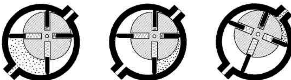
Fig.3. 5. Esquema del funcionamiento del compresor de paletas.
