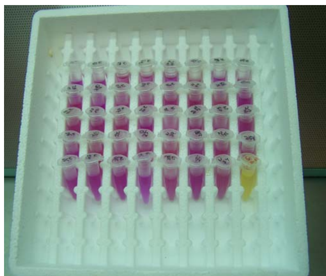
Figura 2. Determinación de la degradación cualitativa de la arginina en medio Thornley modificado. El color lila es degradación positiva. El amarillo es degradación negativa.
