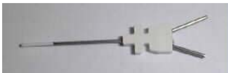
Figura 50: Esquema dels components d'una sonda de microdiàlisi i fotografia de la sonda de microdiàlisi MAB2, Microbiotech, Estocolm, Suècia, utilitzada en els experiments.
