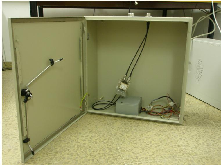
Figura A.4: Caja metálica para proteger a filtros y equipos de interferencias radiadas.
