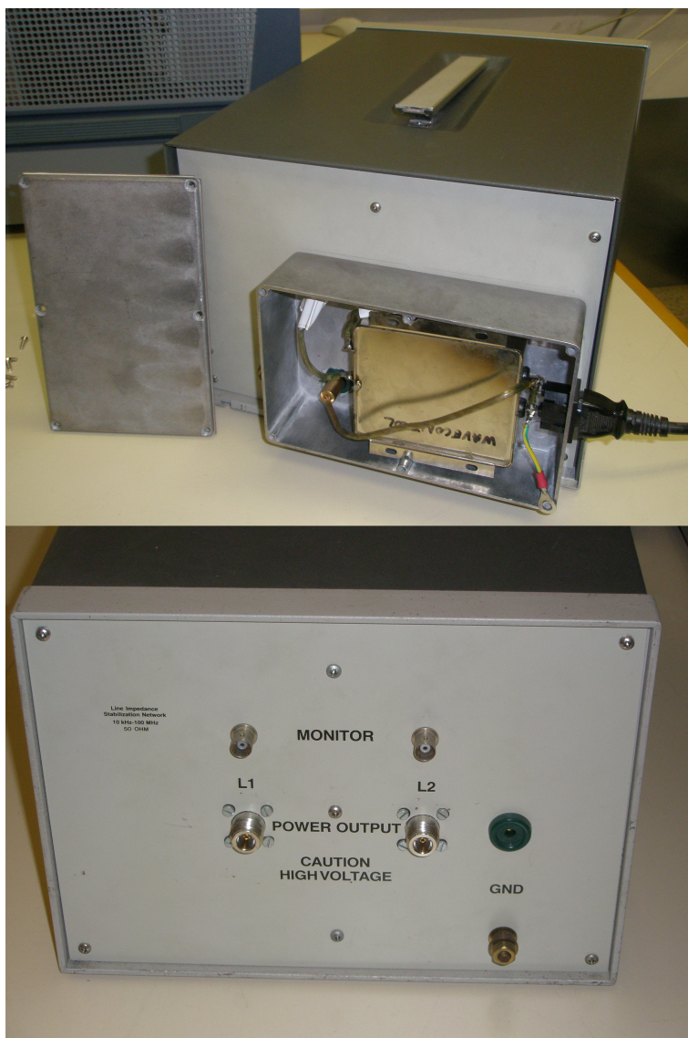
Figura A.5: LISN modificada para mejorar el comportamiento frente a interferencias conducidas de la red eléctrica (arriba). Conexión de equipos de prueba y analizador de redes (abajo).
