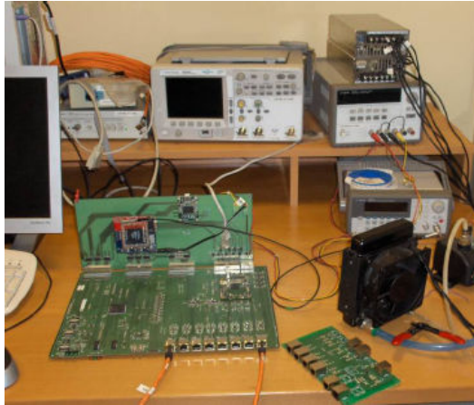
Figura 4.2. Imatge de la CB connectada a la placa de test del sistema.
