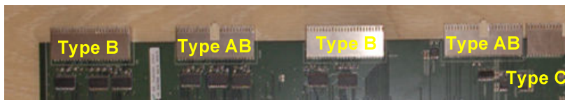
Figura 2.43. Tipus de connectors HM de 2mm de la CB. Detall d'un connector femella de tipus AB.
