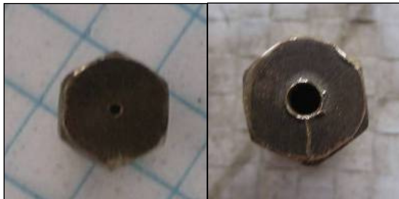
Foto 57 (a) Niple original – (b) Niple modificado para uso con biogás
