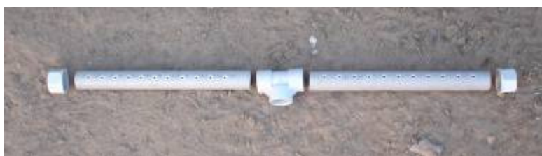
Foto 78, Detalle de conexión de entrada en "T".
