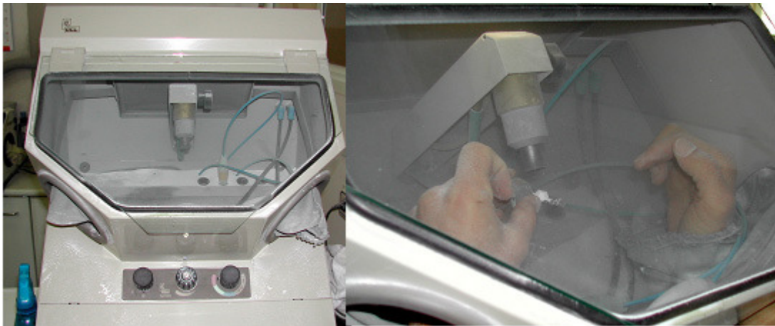
Figura 23. Máquina arenadora partículas óxido de aluminio y perlas de brillo
