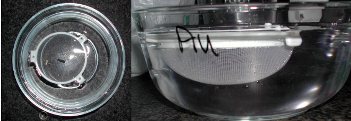
Figura 42. Muestras sumergidas en agua con implante suspendido
