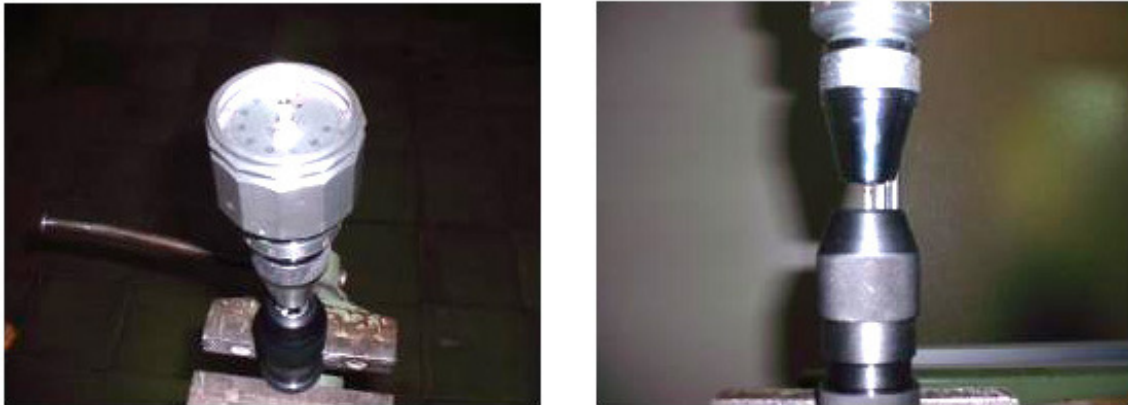
Figura 45. Ensayo de torsión con torquímetro Tohnichi.
