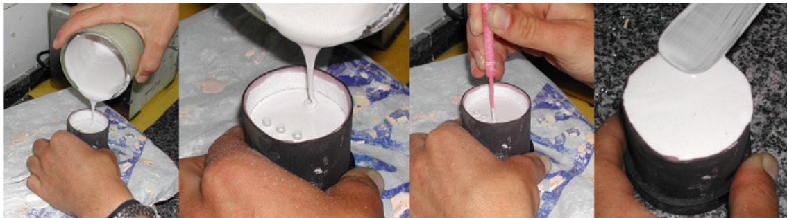
Figura 17. Preparación cilindro de revestimiento
